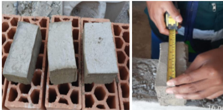
En la Fotografía 2 se ilustra que cada tratamiento experimental se aplicó a tres unidades experimentales (ladrillos individuales moldeados con dimensiones estándar de 14.00 × 9.00 × 7.50 cm), fabricados en condiciones homogéneas para garantizar la reproducibilidad. Las unidades fueron seleccionadas aleatoriamente para las pruebas de compresión, absorción y densidad.
