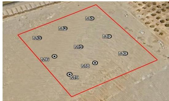
En la Figura 1 se detallan los puntos seleccionados, los cuales fueron geolocalizados para la toma de muestras. También, se limpió el área y se extrajo suelo a una profundidad aproximada de 30 cm. El material fue homogeneizado y cuarteado, eliminando piedras y material grueso.
